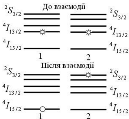
Рис. 3. Ап-конверсійний перехід в парі йонів \text{Er}^{3+} . Пунктирними стрілками показані безвипромінювальні процеси, суцільними – випромінювальні. Символ „ \odot ” показує, що даний йон знаходиться в збудженому стані [44].
